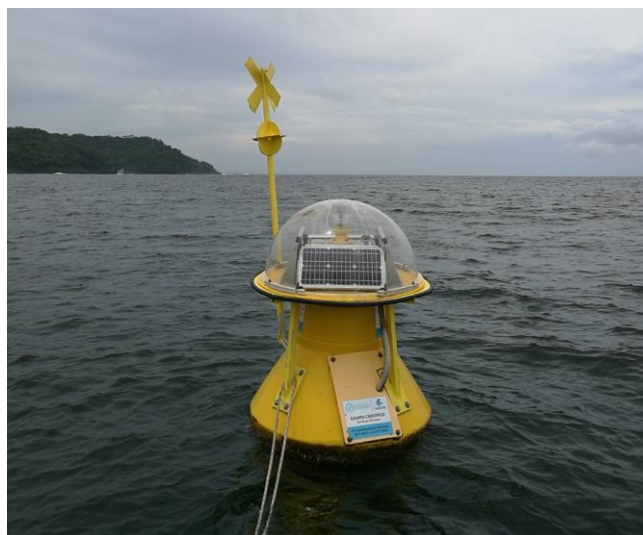
Figura No. 1. Boya de medición instalada en Caldera.
